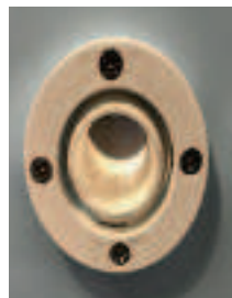
Om kulans säte inte följer med fronten behöver också den skruvas bort
