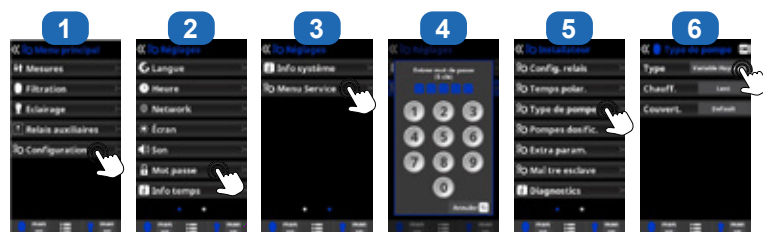
Schéma d'installation d'une pompe à vitesse variable sur Le Control Station NG
